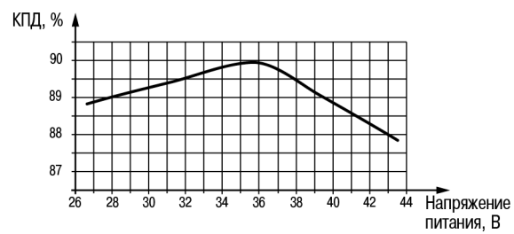
Рисунок 6.3 – График зависимости КПД от напряжения питания (от АКБ)
