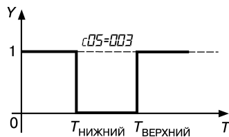
Рис. 3.17. Компаратор срабатывает вне установленных пределов
